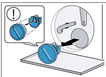
La tapa de la bomba consta de dos componentes que se pueden desmontar para su limpieza.
