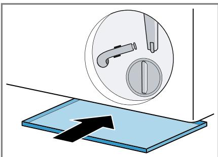
6. Extraer el tubo de drenaje de la sujeción.
