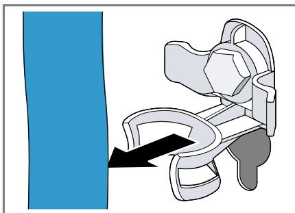
2. Aflojar ① y retirar ② los tornillos de los cuatro seguros de transporte con una llave de tuercas SW13.
