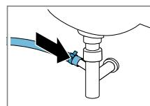
Asegurar el punto de conexión con una abrazadera (24-40 mm).
