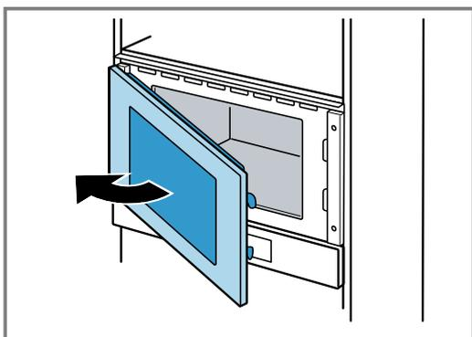
4. Fixați ferm aparatul pe corpul de mobilier, pe partea opusă balamalelor.
