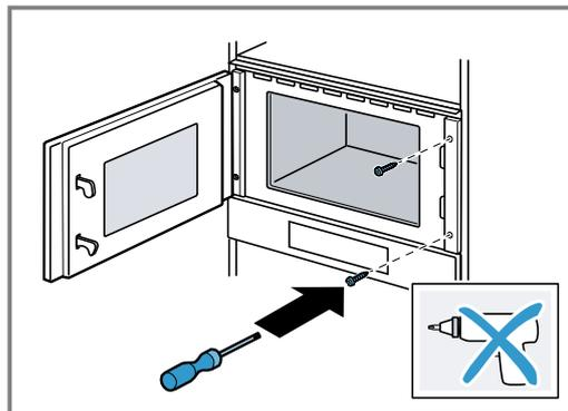
5. Executați în prealabil, pe corpul de mobilier, găurile pentru îmbinarea filetată de pe partea balamalelor.
