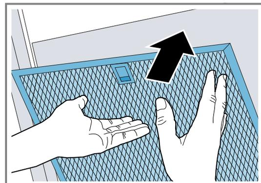
4. Si le filtre à graisse a été mal inséré, poussez avec précaution le loquet vers l'avant, retirez le filtre à graisse et insérez-le correctement.
