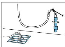
Odvodno crijevo za vodu fiksirajte koljenom
