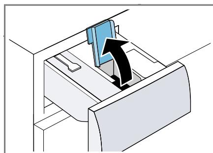
3. Tekući deterdžent  $\Delta$  i omekšivač  $\otimes$  ulijte u odgovarajuće spremnike za doziranje.
