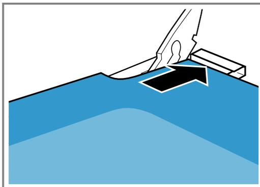
Accertarsi che il pannello si infili nelle due aperture nella parte inferiore. La superficie liscia del pannello deve essere rivolta verso l'esterno.
