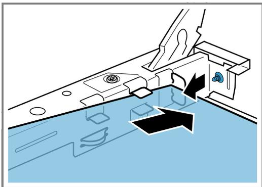
2. Tenere il pannello superiore da entrambi i supporti e inserirlo inclinandolo e spingendolo verso la parte posteriore.
