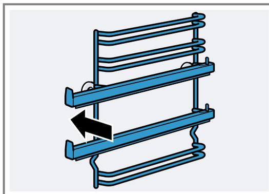
Les supports s'adaptent à droite et à gauche. Les niveaux d'enfournement 1 et 2 se trouvent en bas, les niveaux d'enfournement 3, 4 et 5 en haut. Extrayez le rail de sortie vers l'avant.
