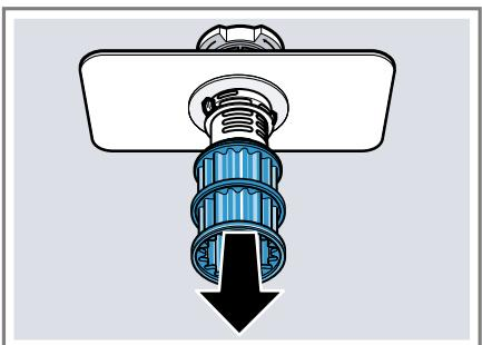
4. Стисніть фіксатори ① і вийміть фільтр грубого очищення вгору ②.
