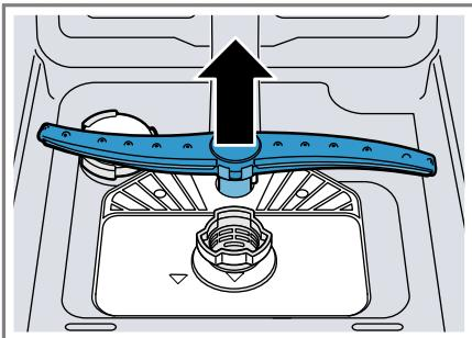
3. Під проточною водою перевірте, чи не засмічено випускні сопла розпилювальних коромисел; за потреби приберіть звідти сторонні предмети.
