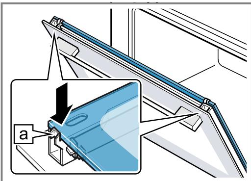
8. Встановіть і притисніть захисну панель дверцят ① до чутного звуку фіксації.
