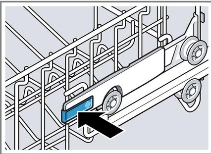
4. Den Geschirrkorb auf die passende Stufe gleichmäßig absenken oder anheben.
