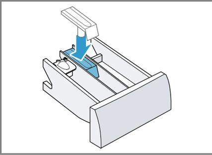
6. Die Öffnung für die Waschmittelschublade reinigen.
