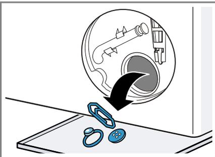
3. Sicherstellen, dass sich das Flügelrad der Laugenpumpe drehen lässt.
