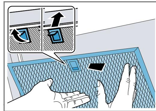
3. Se il filtro antigrasso è stato inserito in modo errato, premere con cautela verso la parte anteriore del dispositivo di bloccaggio, rimuovere il filtro antigrasso e innestarlo correttamente.
