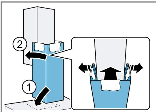
7. Agganciare il rivestimento del camino inferiore alla staffa di fissaggio inferiore. Prestare attenzione a che il cavo di collegamento non resti incastrato.
