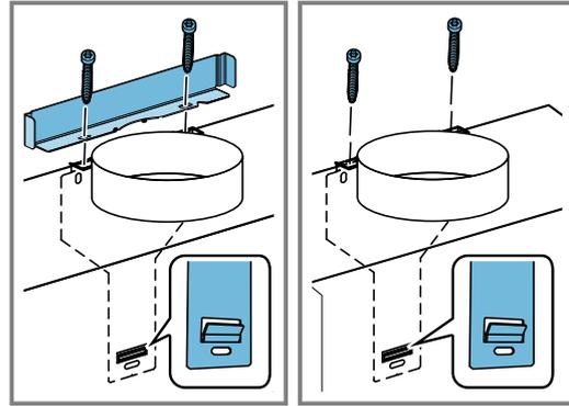
Se si monta un rivestimento del camino, montare l'angolare e durante il serraggio tenere saldamente le viti.
