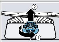
2. Das Grobsieb gegen den Uhrzeigersinn drehen ① und das Siebsystem herausnehmen ②.
