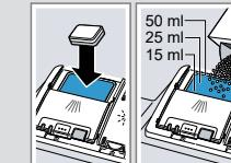
2. Den Deckel der Reinigerkammer schließen.
