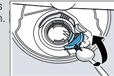
4. Die Pumpenabdeckung mit Hilfe eines Löffels aushebeln und am Steg fassen.
