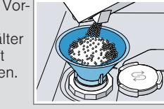
3. Das Spezialsalz in den Vorratsbehälter für Spezialsalz einfüllen. Das Wasser im Vorratsbehälter wird verdrängt und läuft ab. Nie Reiniger einfüllen.
