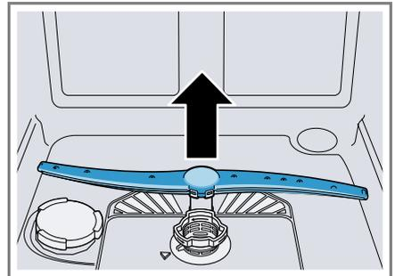
3. Unter fließendem Wasser die Ausstrittsdüsen der Sprüharme auf Verstopfungen prüfen und gegebenenfalls Fremdkörper entfernen.
