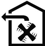
Zrak se ne smije odvoditi u dimnjak, koji se koristi za ispušne plinove uređaja, koji izgaraju plin ili druga goriva (to ne vrijedi za uređaje s optočnim zrakom).
