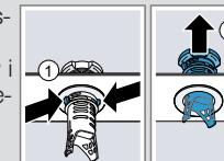
5. Očistite elemente sita pod mlazom tekuće vode.
