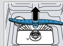
3. Pod mlazom tekuće vode provjerite ima li zaprljanja u izlaznim mlaznicama prskalica i po potrebi ih uklonite.
