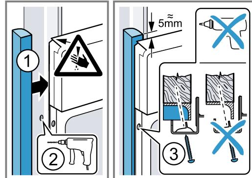
**Merk:** Glipen mellom arbeidsplate og apparat må ikke lukkes av lister e.l.
