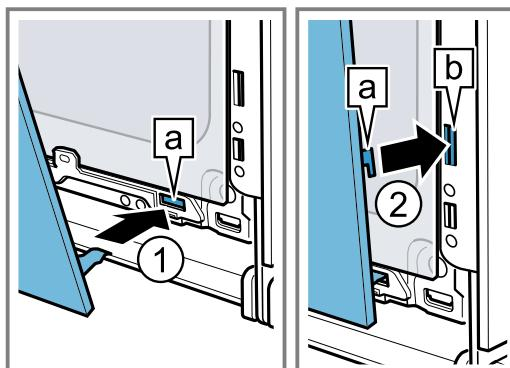
6. Trykk på nedre del av frontruten ① inntil den smekker hørbart på plass.
