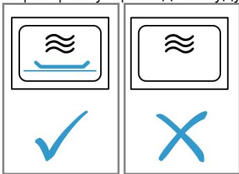
При приготуванні попкорну кілька разів поспіль в мікрохвильовій печі з дуже високою потужністю мікрохвиль робоча камера може пошкодитися.
