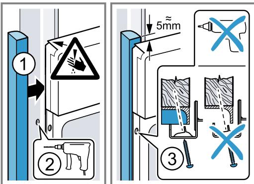
**Napomena:** Otvor između radne ploče i uređaja ne smije se zatvarati dodatnim letvicama.
