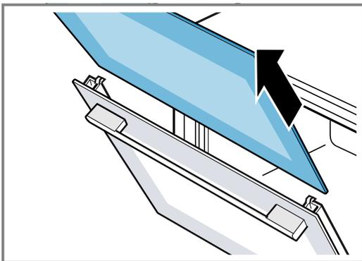
7. Si nécessaire, vous pouvez enlever la baguette de condensation pour le nettoyage.
