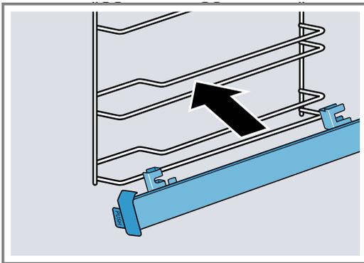
2. Introduisez la fixation [a] entre la barre inférieure et la barre supérieure.
