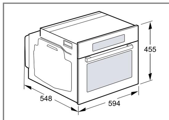
**29.3 Einbau unter einer Arbeitsplatte**
