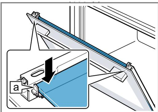
5. Die Gerätetür öffnen und Türdichtung einhängen.
