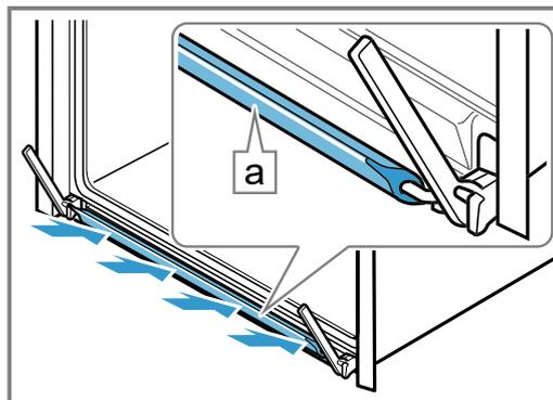
2. Die Gerätetür gerade auf die beiden Scharniere schieben ①. Die Gerätetür bis zum Anschlag schieben.
