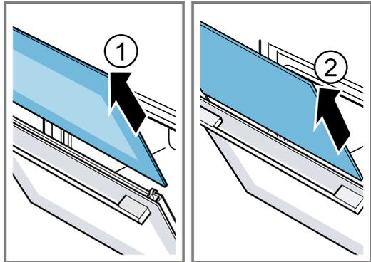
8. Die Gerätetür öffnen und Türdichtung abnehmen.
