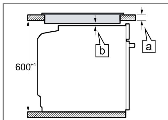
En función de la separación mínima requerida [b] se determina el grosor mínimo de la encimera [a].
