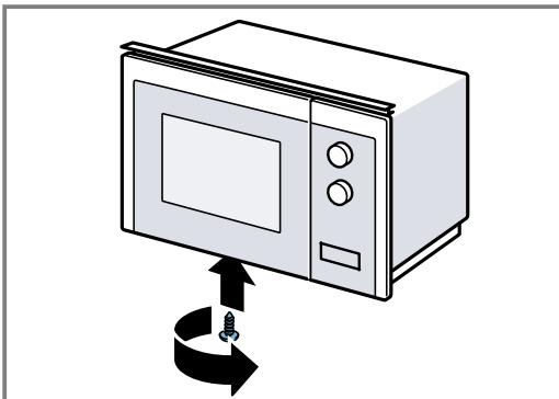
4. Otpustite 2 vanjska vijka na dnu mikrovalne pećnice.
