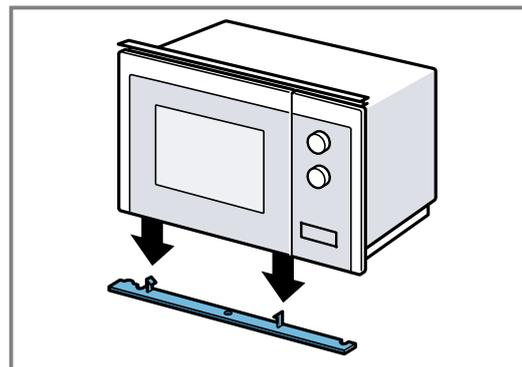
3. Die mittlere Schraube am Mikrowellenboden festschrauben.
