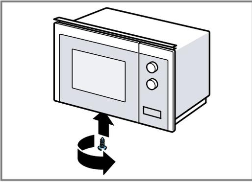
4. De 2 buitenste schroeven aan de bodem van de magnetron losdraaien.
