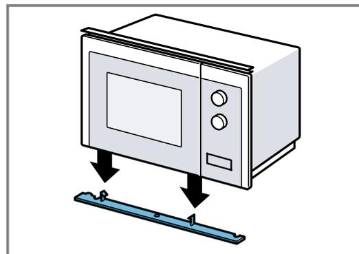
3. De middelste schroef aan de bodem van de magnetron vastschroeven.
