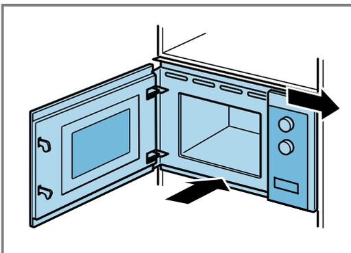
3. Kencangkan alat hingga alat berada di posisi tengah.
