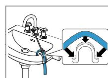
Fissare e assicurare il raccordo di scarico dell'acqua con un collettore → Pagina 30.
