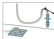
Fissare e assicurare il raccordo di scarico dell'acqua con un collettore → Pagina 30.
