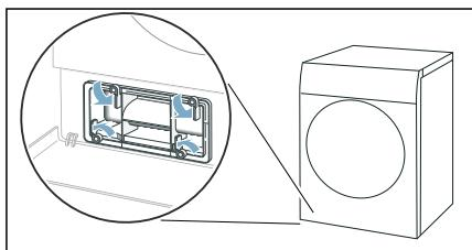
3. Wärmetauscher-Abdeckung am Griff herausziehen.
