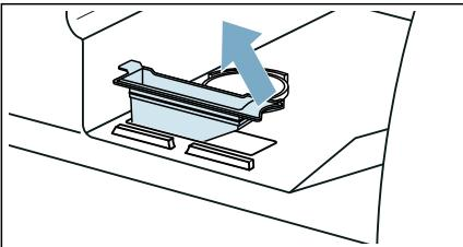
3. Das Sieb in den Wasser-Tank einsetzen.
