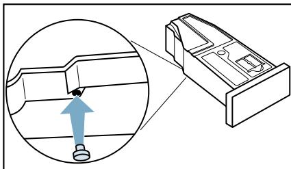
3. Sieb im Kondenswasser-Behälter reinigen. → Seite 57
