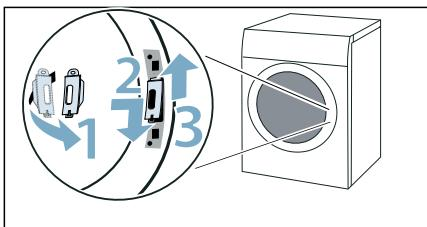
**Hinweis:** Achten Sie darauf, die Dichtung der Tür beim Einsetzen des Ösenteils nicht einzuklemmen oder zu beschädigen.
