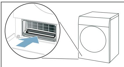
11. Wärmetauscher-Abdeckung am Griff einschieben.
