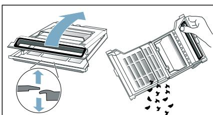
8. Sieb des Flusendepots unter fließendem Wasser gründlich abspülen und abtrocknen.
