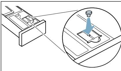
10. Den Kondenswasser-Behälter bis zum Einrasten einschieben.
