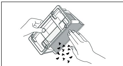
**Hinweis:** Achten Sie darauf, dass keine Verunreinigungen auf den Dichtungen der Wärmetauscher-Abdeckung verbleiben.
