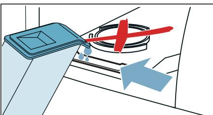
**Hinweis:** Wenn Sie mehr als 180 ml Trinkwasser in das Gerät gießen und im Display **Refresher-Tank leer, bitte füllen** nicht erlischt, wurde das Trinkwasser in die falsche Einfüllöffnung gegossen oder das Gerät nicht korrekt ausgerichtet. Gießen Sie das Trinkwasser in die vordere Einfüllöffnung oder richten Sie das Gerät korrekt aus. → "Gerät aufstellen" auf Seite 13
