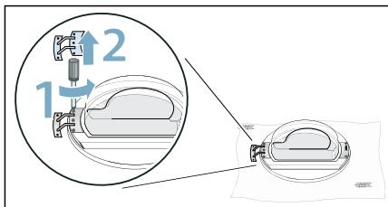
5. Schrauben vom Ösenteil entfernen und Ösenteil entnehmen.
