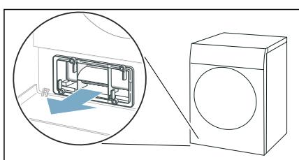
4. Alle Flusen von der Wärmetauscher-Abdeckung und dem Flusensieb entfernen.
