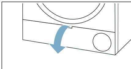
2. Hebel der Wärmetauscher-Abdeckung entriegeln.
