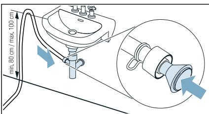
Anschluss-Stelle muss mit Schlauchschelle gesichert werden (Spannbereich 12-22 mm, Fachhandel).
