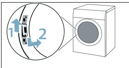
**Hinweis:** Achten Sie darauf, die Dichtung der Tür beim Einsetzen des Gelenks nicht einzuklemmen oder zu beschädigen.
