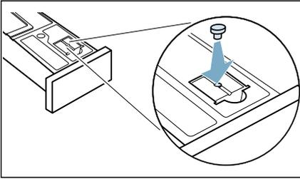
10. Den Kondenswasser-Behälter bis zum Einrasten einschieben.
