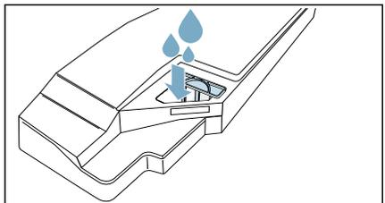
**Hinweis:** Gefüllten Kondenswasser-Behälter immer waagrecht halten, damit keine Flüssigkeit ausläuft.
