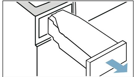
8. Kondenswasser-Behälter um 180° auf die Unterseite drehen und den eingesetzten Stöpsel entfernen.
