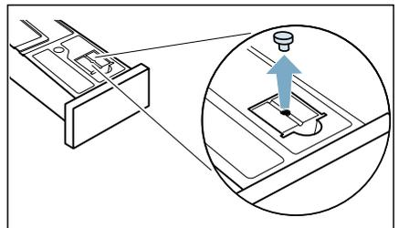
2. Kondenswasser-Behälter um 180° auf die Unterseite drehen und den Stöpsel einsetzen.
