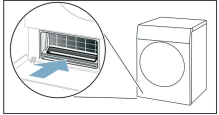
11. Wärmetauscher-Abdeckung am Griff einschieben.
