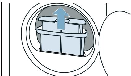
3. Odstráňte vlákna z priehlbiny sitka na vlákna. Dávajte pozor na to, aby do otvorennej šachty nespadli vlákna.
