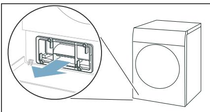
**5.** Filtračnú vložku opatrne vytiahnite z krytu výmenníka tepla.
