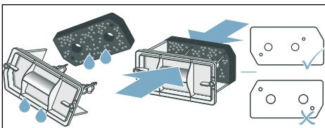
**Avvertenza:** Accertarsi che il materiale filtrante non sia deformato, non presenti crepe o che non sia intasato. Posizionare il materiale filtrante come sopra illustrato.
