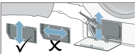
**Avvertenza:** Durante la pulizia prestare attenzione che le lamelle dello scambiatore di calore non siano piegate o danneggiate.
