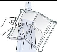
7. Asciugare i filtri per lanugine, chiuderlo e reinserire il filtro per lanugine a due componenti.
