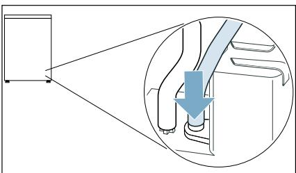
6. Притиснете отточния маркуч във водача на маркуча на уреда.
