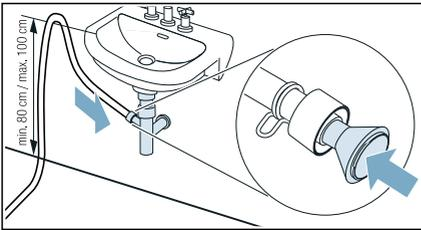
Anschluss-Stelle muss mit Schlauchschelle gesichert werden (Spannbereich 12-22 mm, Fachhandel). Bei Anschluss an einen Siphon ist zu beachten, dass der Ablaufschlauch über eine Höhe von min. 80 cm, jedoch max. 100 cm geführt wird.
