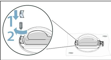
**Hinweis:** Achten Sie darauf, die Dichtung der Tür beim Einsetzen des Ösenteils nicht einzuklemmen oder zu beschädigen.
