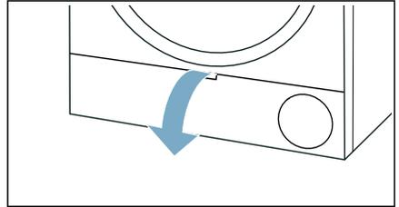
2. Hebel der Wärmetauscher-Abdeckung entriegeln.
