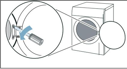
**Hinweis:** Verwenden Sie ausschließlich einen T20 (Torx) Schraubendreher und keine anderen Werkzeuge, um den Türanschlag zu wechseln.
