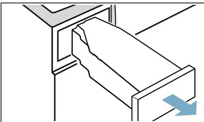
2. Kondenswasser-Behälter bis zum fühlbaren Einrasten wieder in das Gerät schieben.
