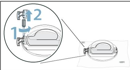
5. Schrauben vom Ösenteil entfernen und Ösenteil entnehmen.
