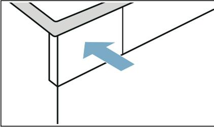
8. Den Kondenswasser-Behälter bis zum Einrasten einschieben.
