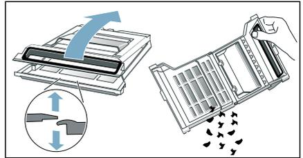
8. Sieb des Flusendepots unter fließendem Wasser gründlich abspülen und abtrocknen.
