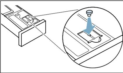
10. Den Kondenswasser-Behälter bis zum Einrasten einschieben.
