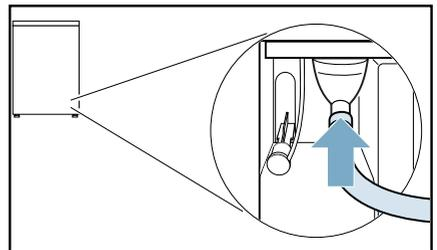
6. Die andere Seite des Ablaufschlauches, je nach Anschluss-Situation, mit dem restlichen Zubehör befestigen.
