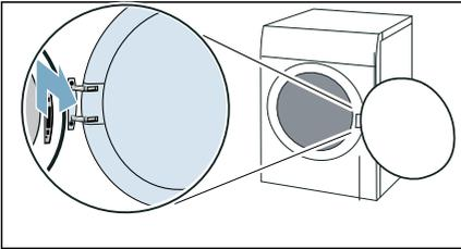
**Hinweis:** Achten Sie darauf, die Tür nicht zu beschädigen oder zu zerkratzen, indem Sie z. B. ein weiches Handtuch unterlegen.
