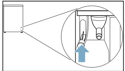
5. Ablaufschlauch bis zum Anschlag auf den freiliegenden Stutzen schieben.
