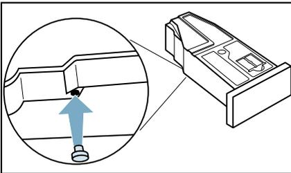
3. Sieb im Kondenswasser-Behälter reinigen. → Seite 55
