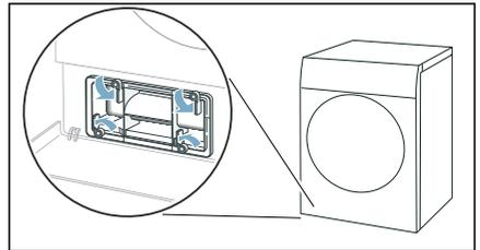
3. Wärmetauscher-Abdeckung am Griff herausziehen.
