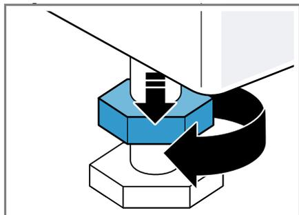
2. Pour aligner l'appareil, tournez les pieds de l'appareil. Vérifiez l'horizontalité avec un niveau à bulle.
