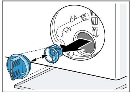
2. Nettoyez le compartiment intérieur, le filetage du couvercle de la pompe et le carter de pompe.
