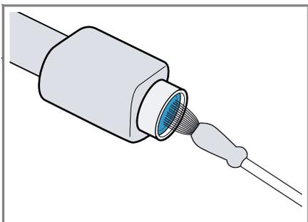
3. Raccordez le flexible d'arrivée d'eau et vérifiez son étanchéité.
