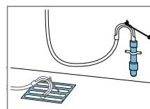
Odvodno crijevo za vodu fiksirajte i osigurajte koljenom .
