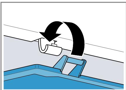
3. Τοποθετήστε το δοχείο διατήρησης φρεσκάδας.
