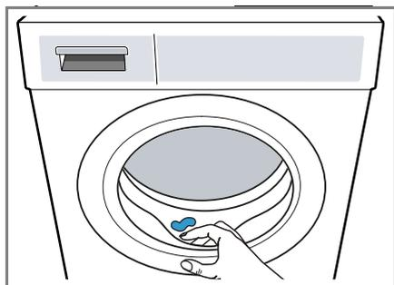
3. Dejar el compartimento para detergente y la puerta de aparato abiertos para que pueda secarse el agua residual.
