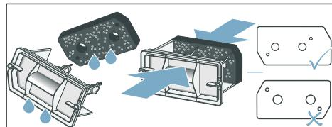
**Remarque :** Veiller à ce que la natte filtrante ne soit pas déformée, ni déchirée ou obstruée. Positionner la natte filtrante comme l'indique la figure en haut.
