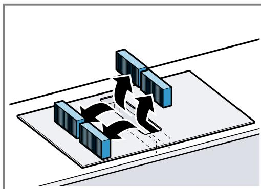
4. De 2 geurfilters of akoestische filters links en rechts in het apparaat plaatsen en naar voren schuiven.
