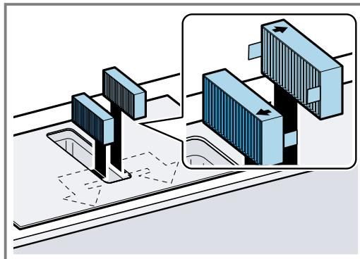
5. De andere geurfilters of akoestische filters links en rechts in het apparaat plaatsen.
