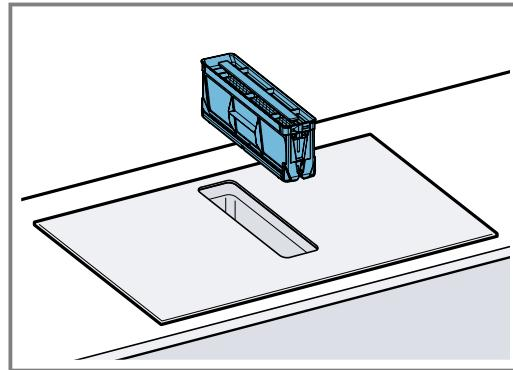
2. Het vetfilter reinigen.
