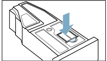
12. Den Kondenswasser-Behälter bis zum Einrasten einschieben.
