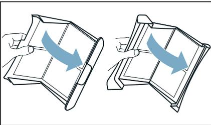
8. Flusensiebe abtrocknen, zuklappen und wieder einsetzen.
