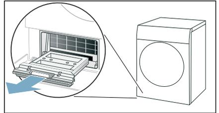
7. Einsatz unter fließendem Wasser abspülen und abtrocknen.
