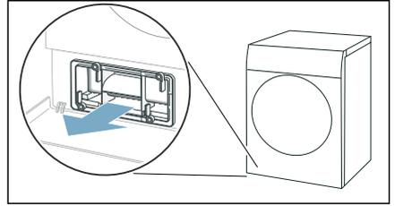
5. Wärmetauscher-Abdeckung mit weicher Bürste reinigen.
