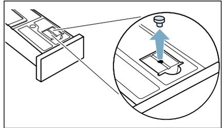
3. Kondenswasser-Behälter um 180° auf die Unterseite drehen und den Stöpsel einsetzen.
