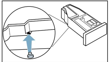
4. Sieb bis zum fühlbaren Einrasten einsetzen.
