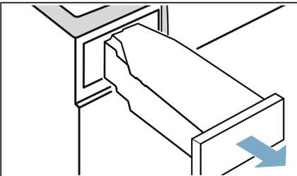
9. Den Kondenswasser-Behälter bis zum Einrasten einschieben.
