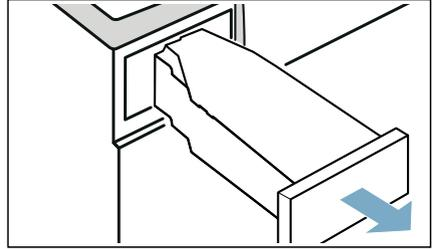
7. Eine Flasche des Original-Pflegemittels und ca. 1 ½ Liter warmes Leitungswasser in den Kondenswasser-Behälter füllen.
