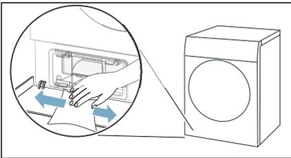
3. Hebel der Wärmetauscher-Abdeckung entriegeln.
