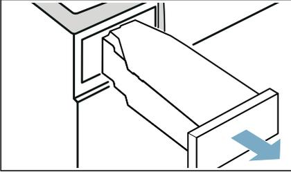
10. Kondenswasser-Behälter waagrecht herausziehen und entleeren.
