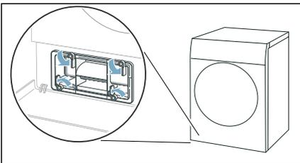
4. Wärmetauscher-Abdeckung am Griff herausziehen.
