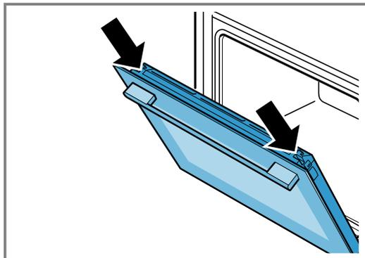
**3. Die Gerätetür ganz öffnen. 4. Den Sperrhebel am linken und rechten Scharnier zugeklappen.**
