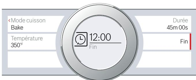
5. Démarrer à l'aide de la touche start/stop (démarrage/arrêt). L'heure à laquelle l'appareil démarre est affichée à l'écran.
