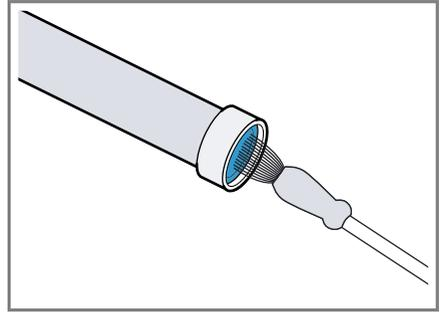
3. Den Wasserzulaufschlauch anschließen und auf Dichtheit prufen.
