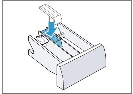
6. Die Öffnung für die Waschmittelschublade reinigen.
