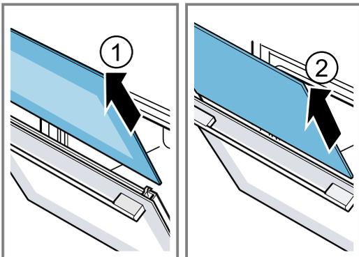
8. Si nécessaire, vous pouvez enlever la baguette de condensation pour le nettoyage.
