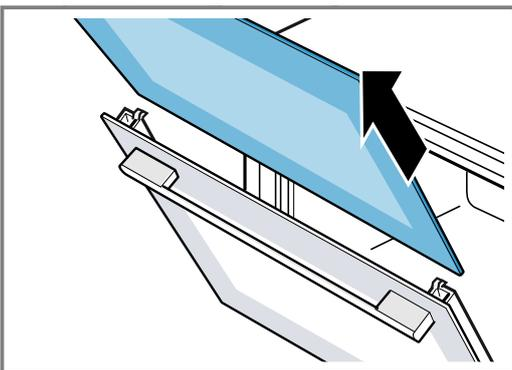
7. Se necessário, retire o friso de condensação para o limpar.
