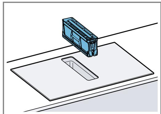
3. Die 4 Geruchsfilter oder Akustikfilter herausnehmen und ordnungsgemäß entsorgen.
