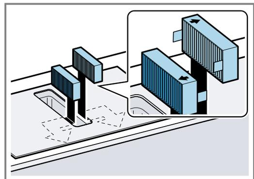
5. Die anderen Geruchsfilter oder Akustikfilter links und rechts in das Gerät einsetzen.
