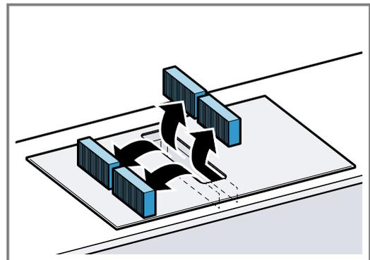
4. Die 2 Geruchsfilter oder Akustikfilter links und rechts in das Gerät einsetzen und nach vorne schieben.
