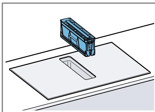
3. Die 4 GeruchsfILTER oder Akustikfilter herausnehmen und ordnungsgemäß entsorgen.
