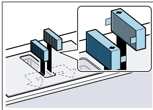
5. Die anderen GeruchsfILTER oder Akustikfilter links und rechts in das Gerät einsetzen.
