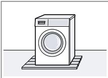
Instale o aparelho sobre uma placa de madeira impermeabilizada fixamente aparafusada ao chão. A placa de madeira deve ter uma espessura mínima de 30 mm.
