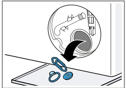
A tampa da bomba é composta por dois componentes que podem ser separados para efeitos de limpeza.
