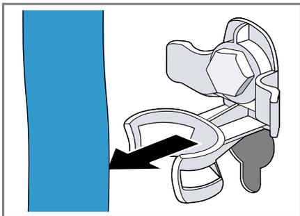
2. Desaperte os parafusos dos 4 dispositivos de segurança para transporte com uma chave tam. 13 e ① retire-os②.
