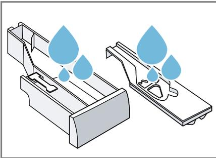
9. Secar e colocar a gaveta para detergente, a tampa e a unidade da bomba.
