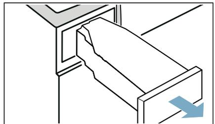
9. Skjut in kondensattanken så att den snäpper fast.
