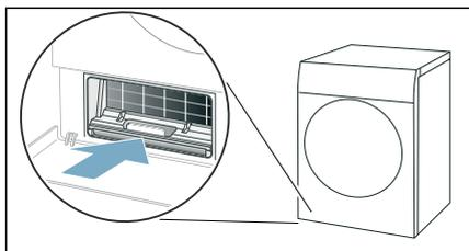
10. Skjut in värmeväxlarskyddet med handtaget.
