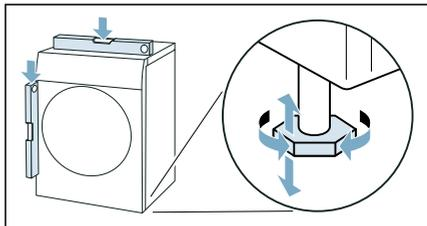
3. Rikta upp maskinen med maskinfötterna, om det behövs. Nu kan du ansluta maskinen.
