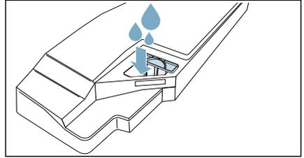
**Anvisning:** Håll kondensattanken horisontellt, så att du inte spillar ut vätskan.
