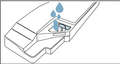
**Anvisning:** Håll kondensattanken horisontellt, så att du inte spillar ut vätskan.
