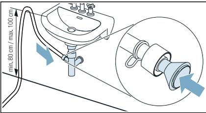
Fäst anslutningen med slangklämma (spännvidd 12-22 mm, finns att köpa i fackhandeln).
