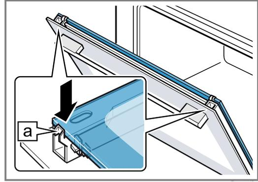
7. Colocar la cubierta de la puerta ① y presionar hasta que se oiga que ha encajado.
