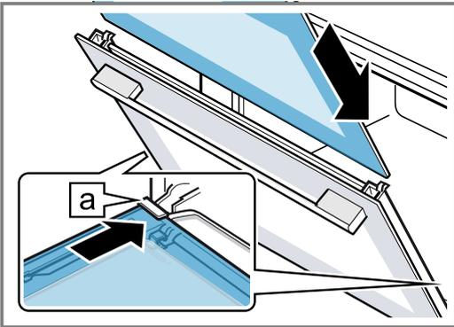
6. Presionar el cristal interior por arriba hasta que quede en la sujeción izquierda y derecha [a].
