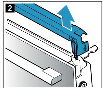
**Hinweis:** Den Edelstahlbleger in der Abdeckung mit Edelstahlreiniger reinigen. Die restliche Türabdeckung mit Spüllauge und einem weichen Tuch reinigen.
