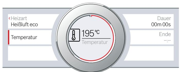
3. Mit Taste start/stop
