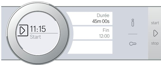
L'appareil est en position d'attente. Lorsque l'appareil démarre, la durée s'écoule dans l'écran.
